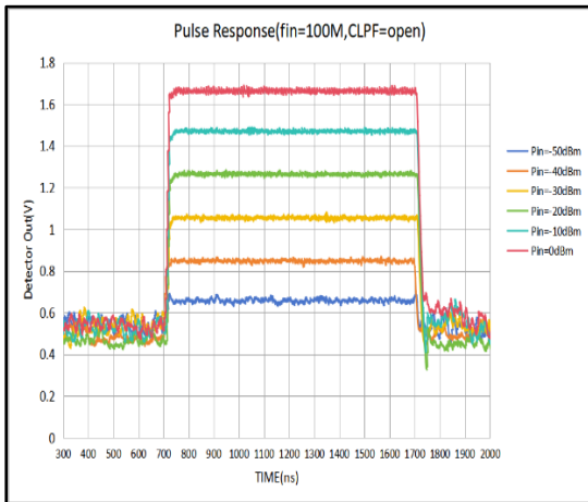
图 11 100MHz 输出瞬态响应, CLPF=Open
